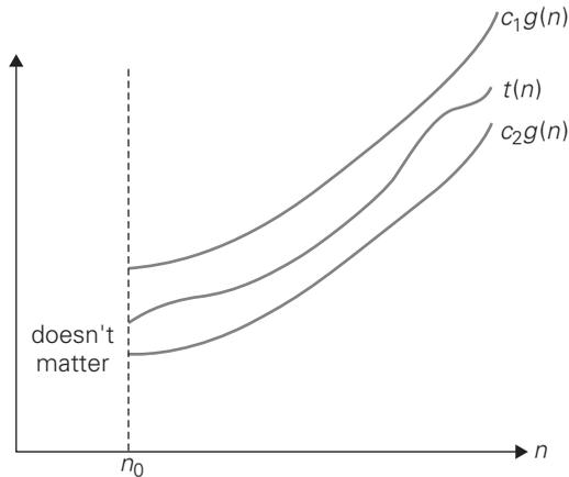
**FIGURE 2.3** Big-theta notation:  $t(n) \in \Theta(g(n))$ .
